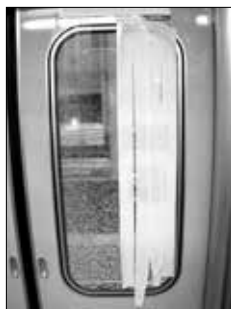
応急処理後の状態
