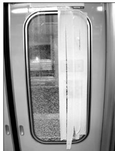
応急処理後の状態
