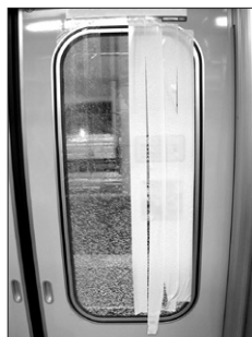
応急処理後の状態
